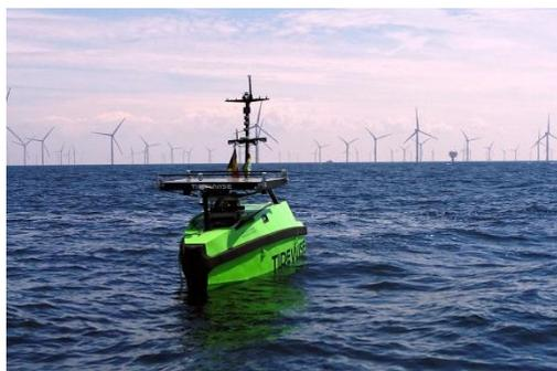
A inspeção realizada pela empresa brasileira foi feita através da integração de um drone a uma embarcação autônoma
